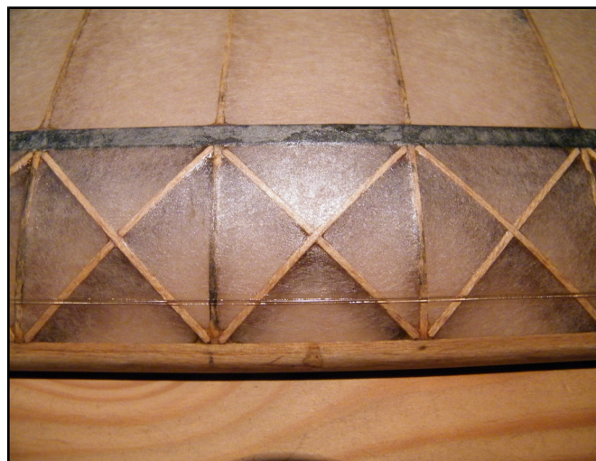
Bild 2: Ausführung der geodätischen Aussteifung an einer Folgeversion des Modells [Foto: AH]
